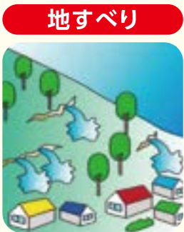
斜面から水が噴き出す
