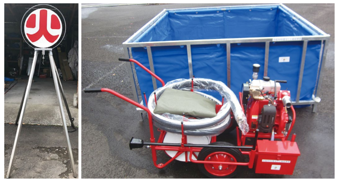
↑樁妃隊に整備された火点（写真左）と軽可搬消防ポンプ
