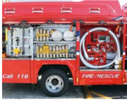
↑CAFSを搭載した消火システム
