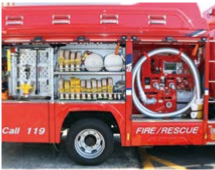
↑C A F S を搭載した消火システム
