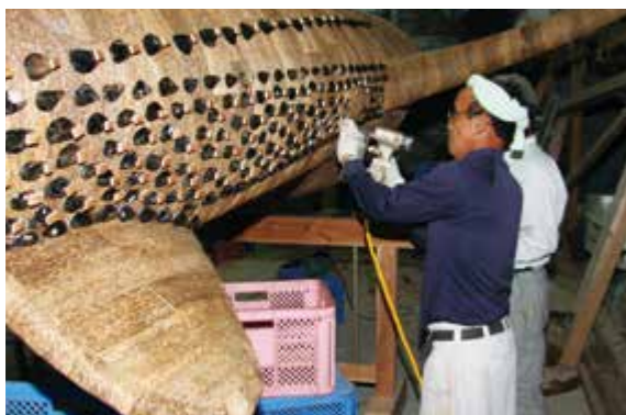
↑貝殻が接着中に落ちないように一つずつ仮止め
