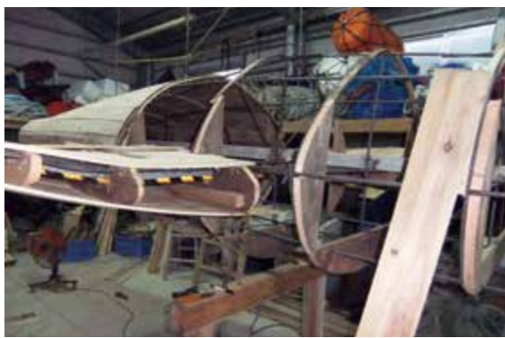
↑胴体内部は鉄筋と番線でしっかり固定
